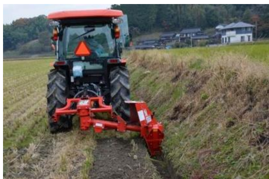
使用挖沟机进行明渠设置作业
